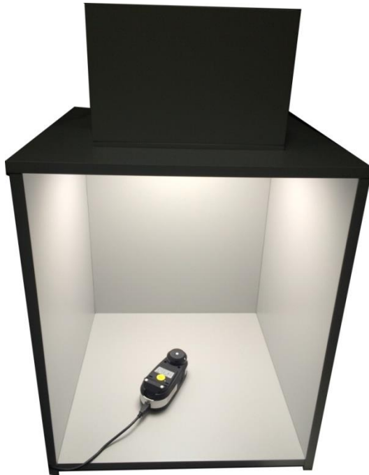
图 4.15. i1 Pro2 带照度头工作平面测量示意图
